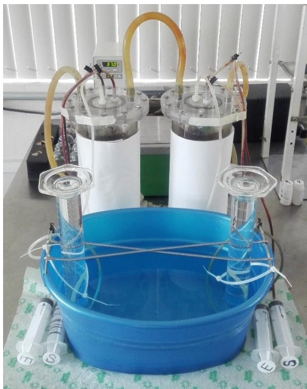
Figura 16. Reactores acoplados a todo el sistema de medición de biogás, a la recirculación de agua, así como al suministro y retiro de sustrato.
