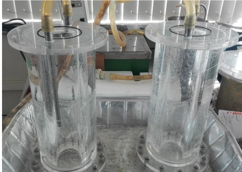
Figura 15. Apariencia de los reactores en forma física. Prueba de ensamblaje y sellado.
