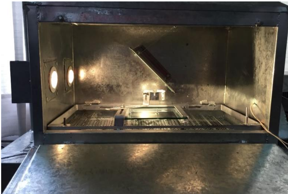
Figura 4.21 Estructura principal de la fase de iluminación con dos lámparas.
