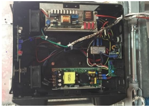
Figura A-9 Estructura física para el control de la lampara final.
