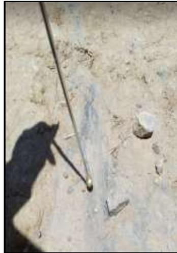
f) *Material arena-limo*, En los depósitos sedimentarios de abanicos aluviales en las laderas del poniente de San Simón se encontraron capas de suelo de granulometría de arena limosa o limos arenosos con algunos fragmentos dispersos de andesita en bloques (**Figura 10**)
