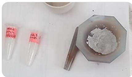
Figura 12. Muestra obtenida a partir del pre-tratamiento térmico (400°C)
