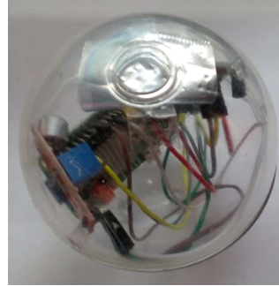
Figura 6 Desarrollo de una esfera que monitorea variables físicas en un desastre natural (terremotos).
