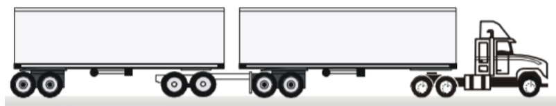
Figura 2.8 Esquema y pesos de vehículo T3-S2-R4. (Secretaría de Comunicaciones y Transportes, 2017)
