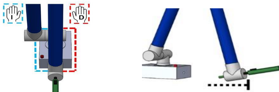
Figura 7. Señalización del espacio que ocupará la base del DH de acuerdo con el lado del cuerpo a rehabilitar (azul brazo izquierdo y rojo brazo derecho).
