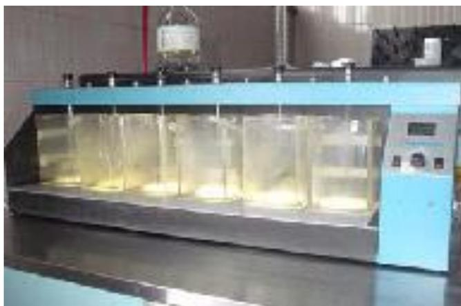
**Figura 14. Equipo PB-700™ PHIPPS&BIRD™ de pruebas de jarras.**
