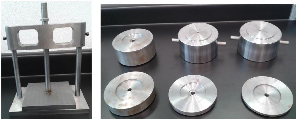
**Figura 2.6** Dispositivo de compresión y pesas de 1, 2, 4, 8, 9, 10 kg.
