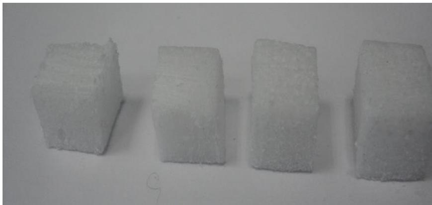
**Figura 2.13 Corte del espécimen a realizar la densidad.**
