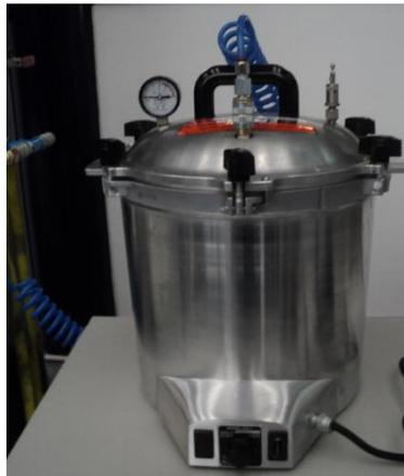
**Figura 2.25 Autoclave para prueba de absorción de agua.**
