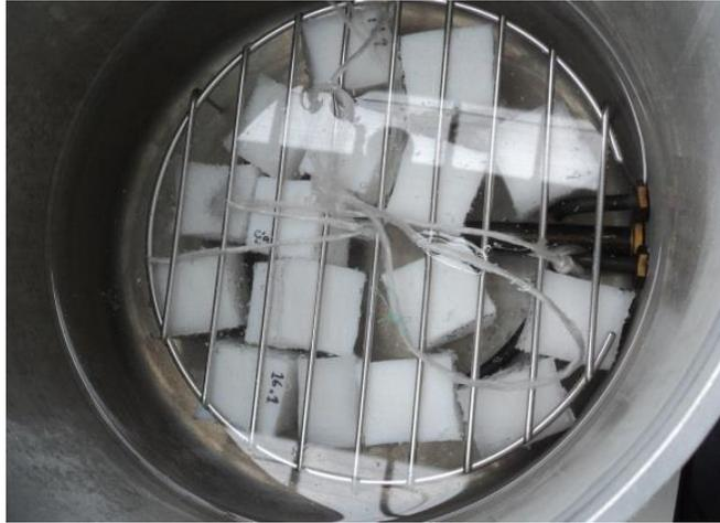
**Figura 2.24 Colocación de muestra en la autoclave.**
