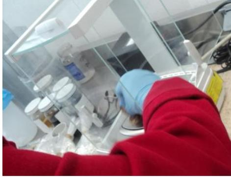
**Figura 2.26 Se pesa la muestra una vez ejecutada la prueba.**
