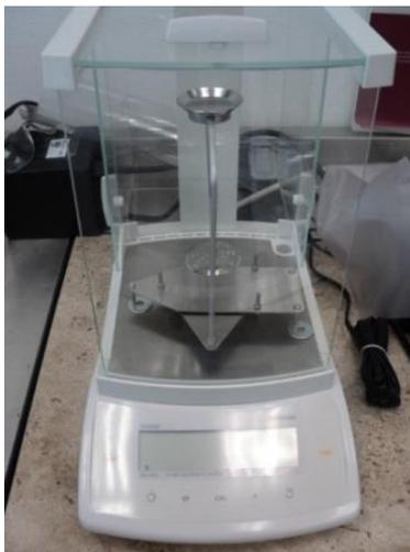
**Figura 2.14 Balanza Analítica con dispositivo de densidad**
