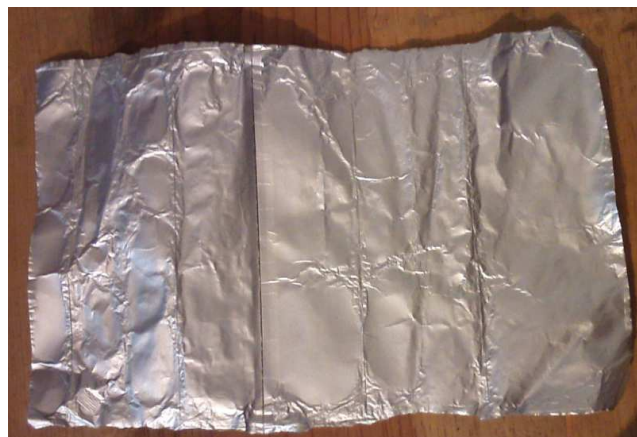
Figura 26. Lámina de Tetra Pak libre de cartón.
