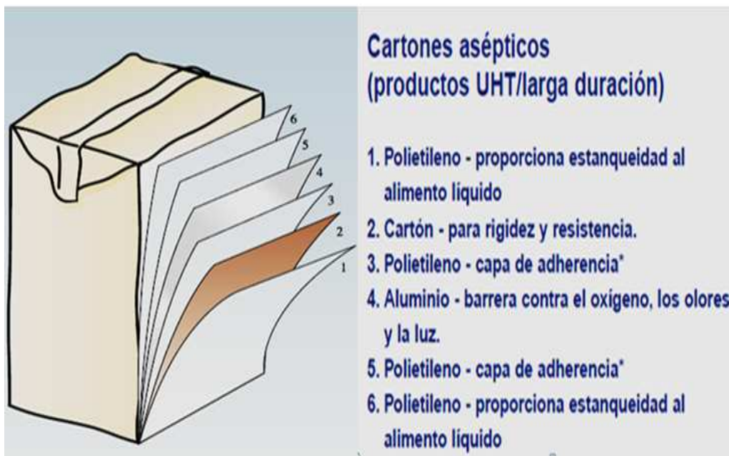
Figura 2. Estructura de un envase flexible Tetra Pak [13].
