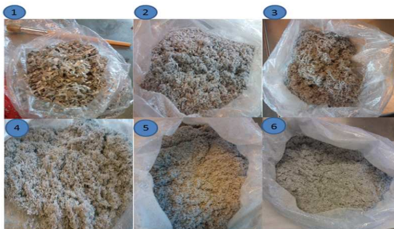
Figura 28. Tamaños de la muestra de Tetra Pak obtenidos después de la molienda.
