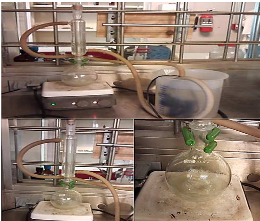
Figura 32. Etapa de lavado del LDPE obtenido a partir de envases Tetra Pak.
