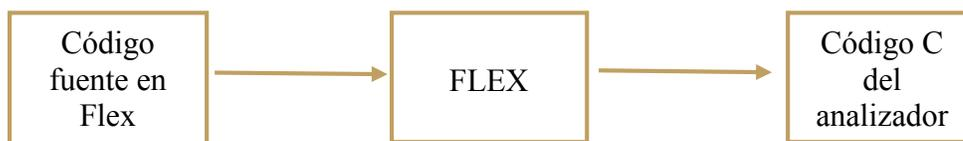
*Figura 9 Flex se encarga de transformar las especificaciones (reglas y acciones) que nosotros definamos a un código C que representa al analizador.*
