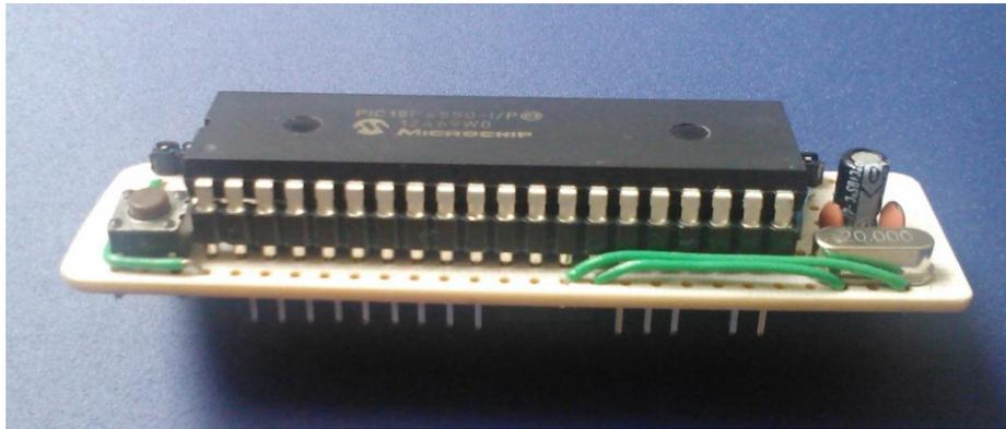
Figura 1.17 Tarjeta de proyectos con PIC18F4550 montado
