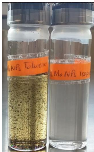
Figura A3. El vial de la izquierda corresponde a la disolución de NPs irradiadas con atmósfera de nitrógeno en tolueno y a la derecha con isopropanol sin atmósfera de nitrógeno utilizando el láser de pulsos cortos (6ns).
