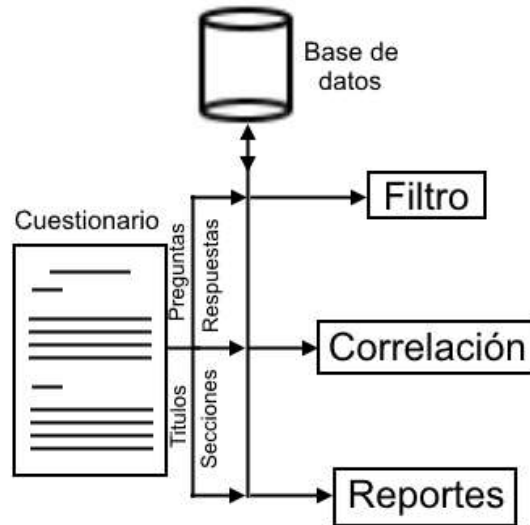
Figura 3.5: Diagrama de la interacción entre el cuestionario, los módulos y la base de datos
