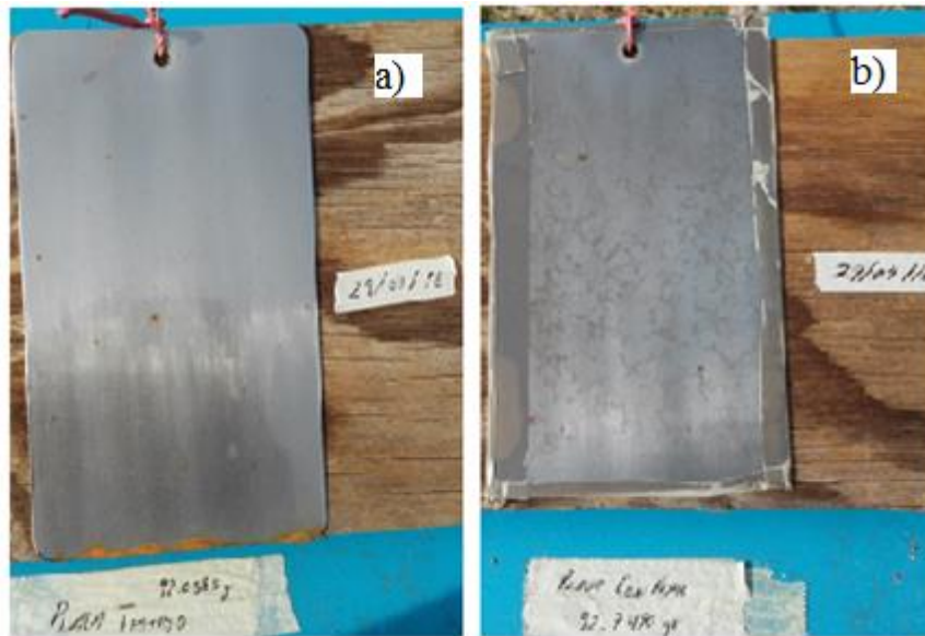
Figura 57. Cupones normalizados expuestos al ambiente. (a) Placa testigo, (b) Placa con EN. Noveno día de exposición. 29/04/16.
