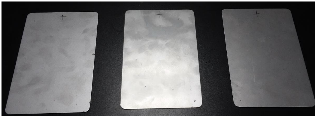
Figura 48. Preparación de cupones normalizados de acero al carbono.
