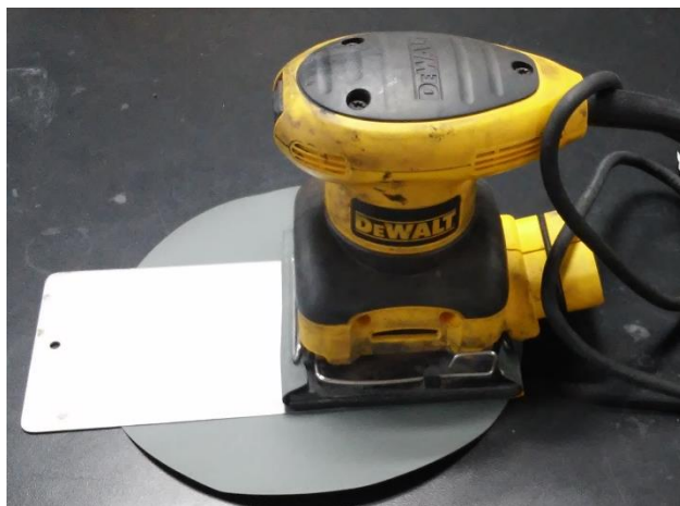
Figura 49. Pulido de cupones normalizados de acero al carbono.
