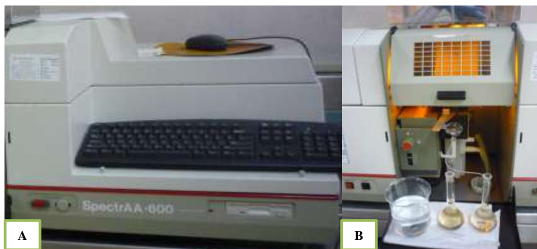
Figura 10. A) Espectrofotómetro de absorción atómica SpectrAA-600 empleado para la determinación de cromo total. B) Medición de cromo total en las muestras.
