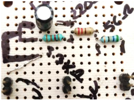
Figura 44. Circuito eléctrico equivalente utilizado para los ajustes de datos de impedancia en el equipo VERSASTAT-4.
