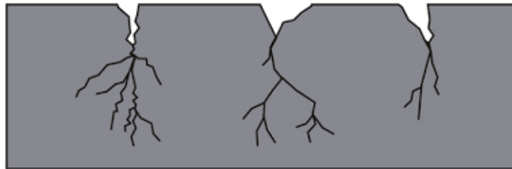
Figura 5. Corrosión por agrietamiento bajo esfuerzos.
