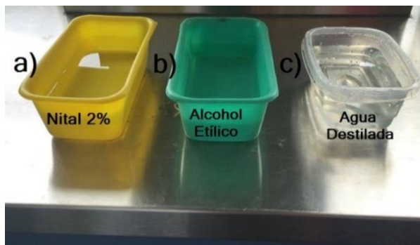
Figura 30. Reactivos utilizados en el proceso de ataque químico de los aceros industriales; a) reactivo Nital al 2%, b) alcohol etílico y c) agua destilada.
