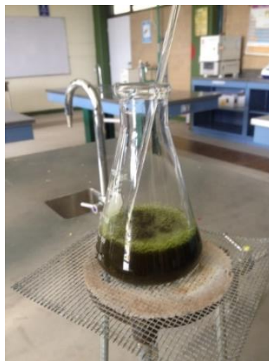
Figura 41. Mezcla homogénea de Morinda Citrifolia y etanol concentrado al 98%.
