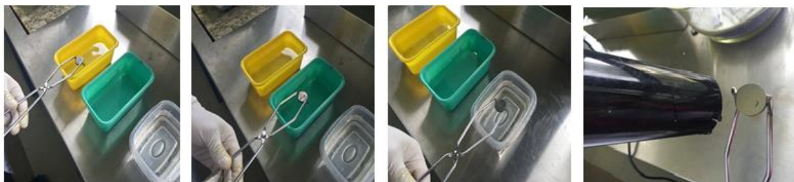
Figura 31. Proceso de exposición a la sustancia Nital al 2% de los aceros industriales.
