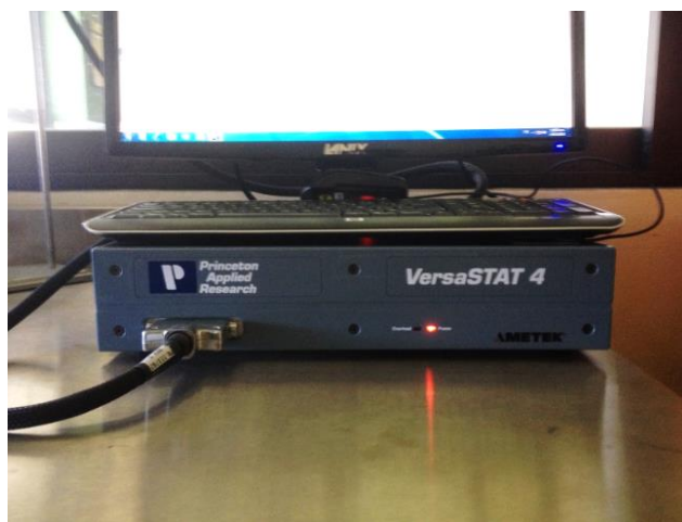
Figura 42. Equipo de medición electroquímica VERSASTAT-4 (potenciostato-galvanostato).
