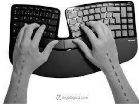
**Figura 24. Teclado con modelo de separación en forma ergonómico que permite una mayor facilidad de uso para aquellas personas con discapacidad motriz.**
