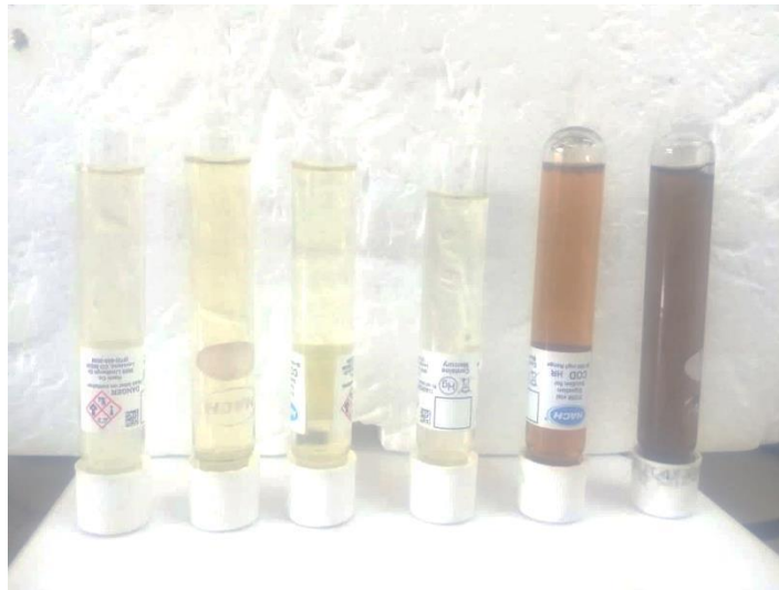
Figura 28. Efecto de la densidad de corriente en la remoción de color, en condiciones óptimas de operación (440 A/m 2 , pH 7.10, Q=20 mL/min), los tiempos 0,100, 125, 150, 175, 200 min.
