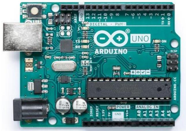
Figura 4.4. Tarjeta de adquisición de datos Arduino UNO Fuente: (Arduino, 2018)
