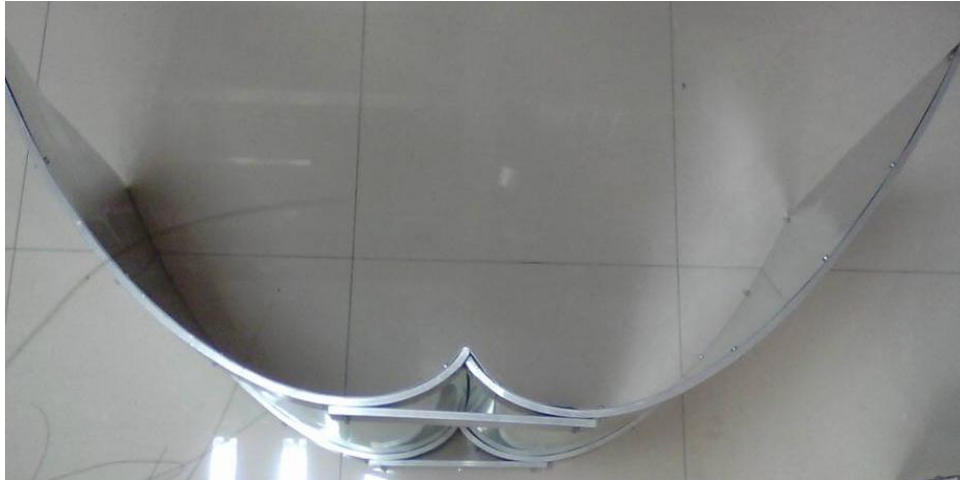
Figura 5.6. Concentrador solar con truncamiento construido.
