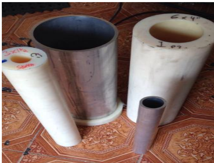
Figura 3.3. Tuberías de aluminio y bujes de nylamid utilizados.
