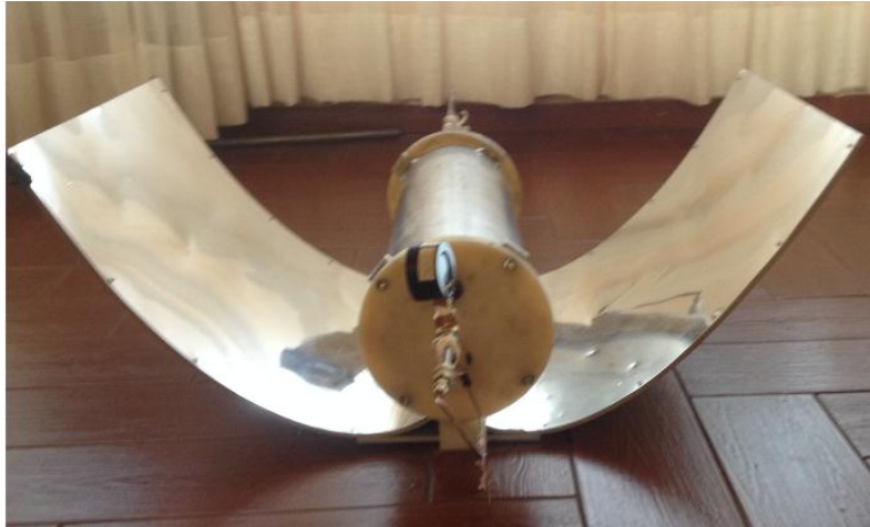
Figura 5.7. Concentrador solar con truncamiento construido.
