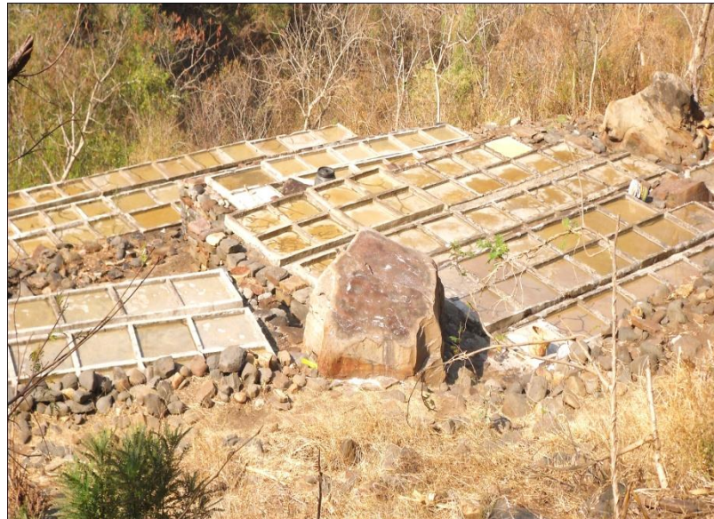
Fig. 59 Evaporación de agua con salmuera en patios para que se cristalice el grano de sal (Foto: Oyuki Valle Cedano).
