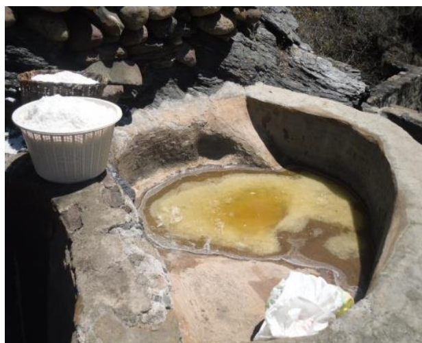
Fig. 47 Filtración de agua mediante un recipiente de plástico, y que es puesto sobre un Tecajete para que se solidifique el grano de sal.
