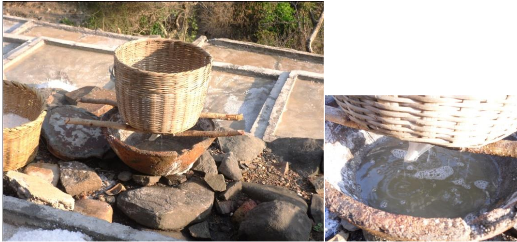
Fig. 62 Filtración de agua con salmuera mediante un chiquihuite sobre una cazuela (Foto: Oyuki Valle Cedano).
