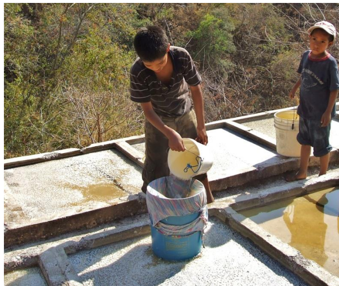
Fig. 58 Omar vaciando el agua con salmuera en una cubeta cubierta con una tela para que salga filtrada en el cuadro (Foto: Miguel A. Guadarrama).
