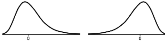
Figura 2.1: Se ilustra lo que es el sesgo con dos f.d.p. que tienen la misma media y desviación estándar. La f.d.p. de la izquierda presenta sesgo positivo mientras que la de derecha esta sesgada negativamente. Fuente: Holton (2014)
