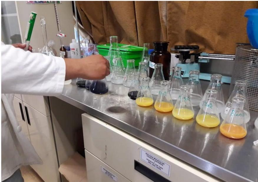
**Figura No. 13.** Proceso de determinación de poder diastásico.
