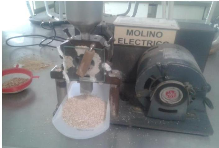
**Figura No. 10.** Molino para la molienda de la malta de Triticale (*X. Triticosecale* W.)
