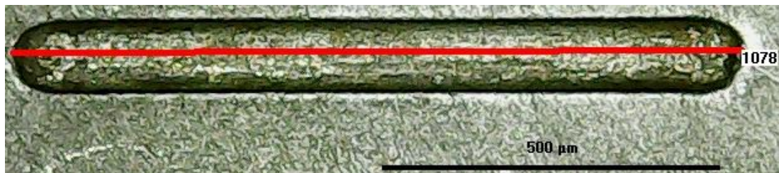
(a) Canal con una profundidad de 240 \mu\text{m} con mediciones de ancho.
