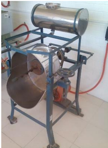
Figura 2. Molino utilizado para la obtención de harina de triticale
