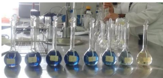
Figura 9: Curva de calibración para determinación de % de amilosa
