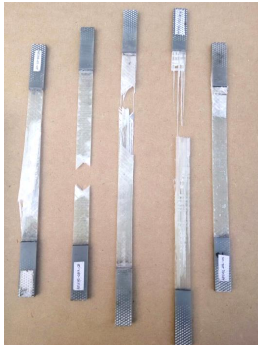
Figura 66 Fallas en pruebas de tensión
