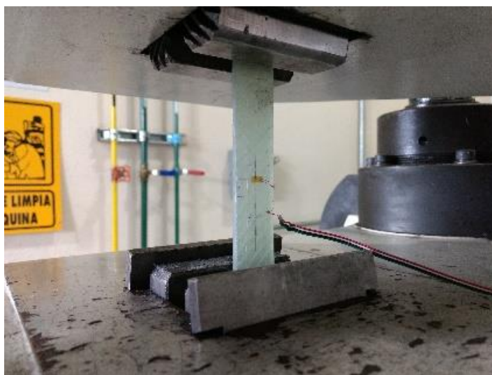
Figura 72 Muestra de pruebas de cortante con galga a 90^\circ
