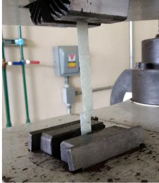
Figura 65 Probeta montada en la máquina universal al final del ensayo.
