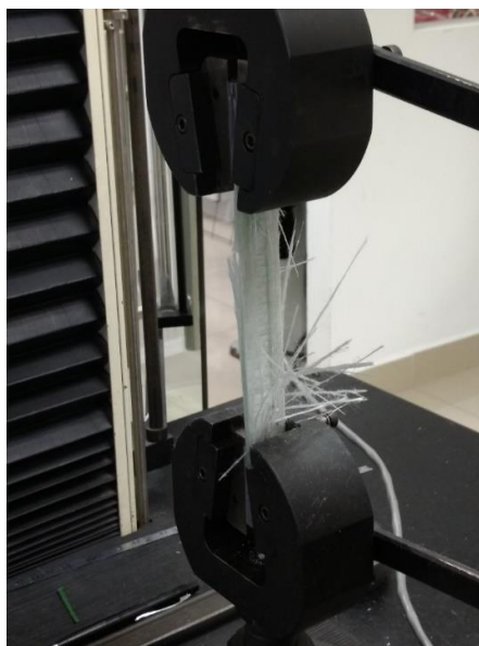
Figura 71 Prueba de ensayo a cortante
