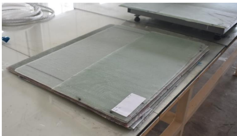
Figura 51 Placas de compuesto terminadas
