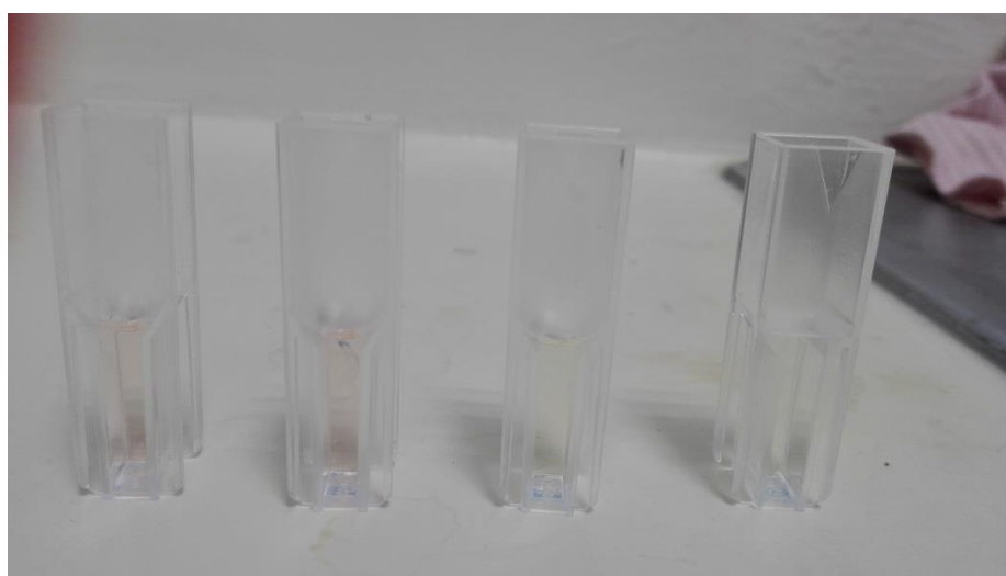
Figura 3. Reacción enzimática catalasa (CAT) en los extractos de carne en los diferentes tratamientos.
