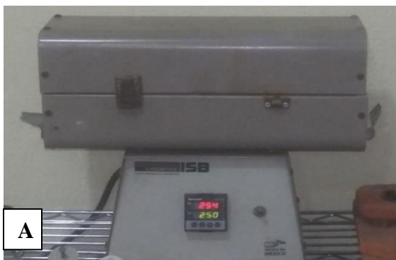
Figura 3.2: A) Horno tubular , B) Estaño metálico .
