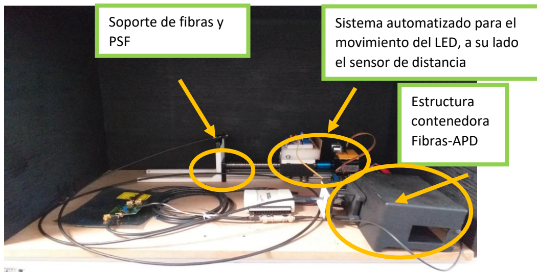
Figura 37 Vista interior del sistema completo de componentes dentro del compartimiento aislante de la luz
