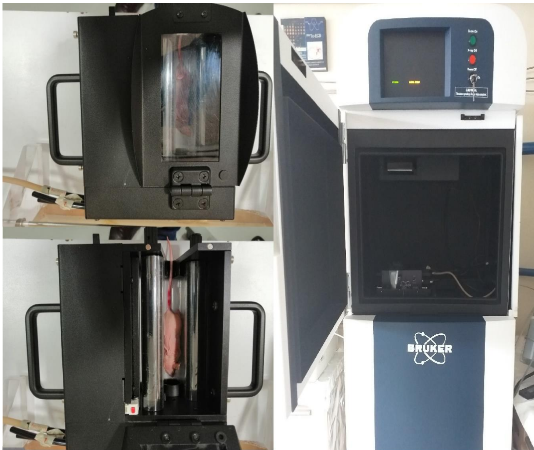
Figura 44 Interior del dispositivo Xtreme II, accesorio MARS, y posicionamiento del ratón en el MARS
