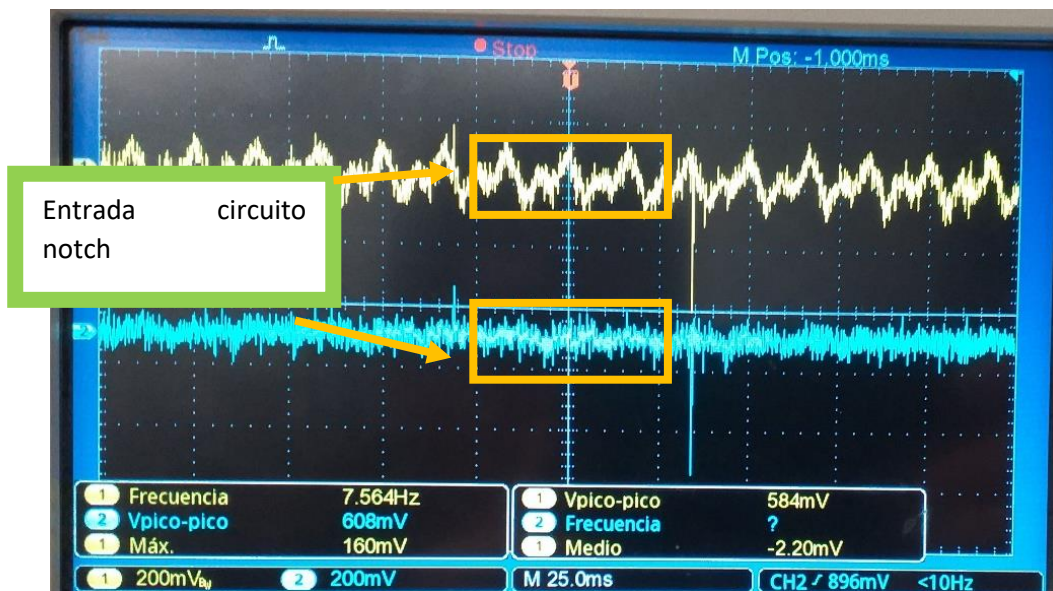
Figura 56 Comparación de la señal de entrada del filtro notch (señal amarilla) y la señal de salida del mismo (señal azul).
