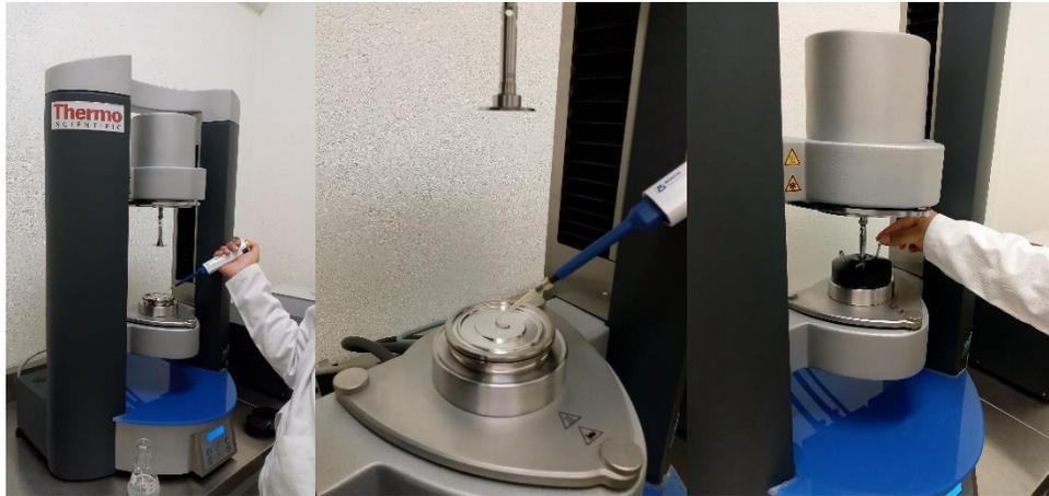
**Figura 3.5.** Procesamiento reológico de muestras. De izquierda a derecha: muestra en el centro de la placa del reómetro, acercamiento del mismo paso y reómetro con cubierta para evitar salpicaduras y en posición de adquisición de datos.
