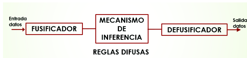
Figura 3.2 Esquema general de un mecanismo de inferencia difuso
