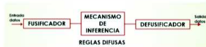
Fig. 4. Esquema general de un mecanismo de inferencia difuso
