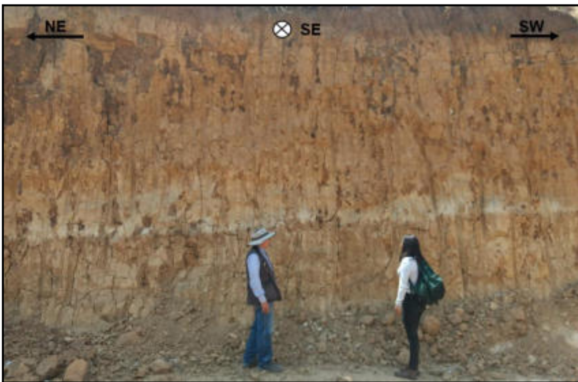
Figura 5.5 Afloramiento de arcillas volcánicas (producto de cenizas volcánicas de caída), estas arcillas tienen una característica peculiar, ya que con la humedad se expanden y cuando se secan se contraen, generando agrietamiento y caída.
