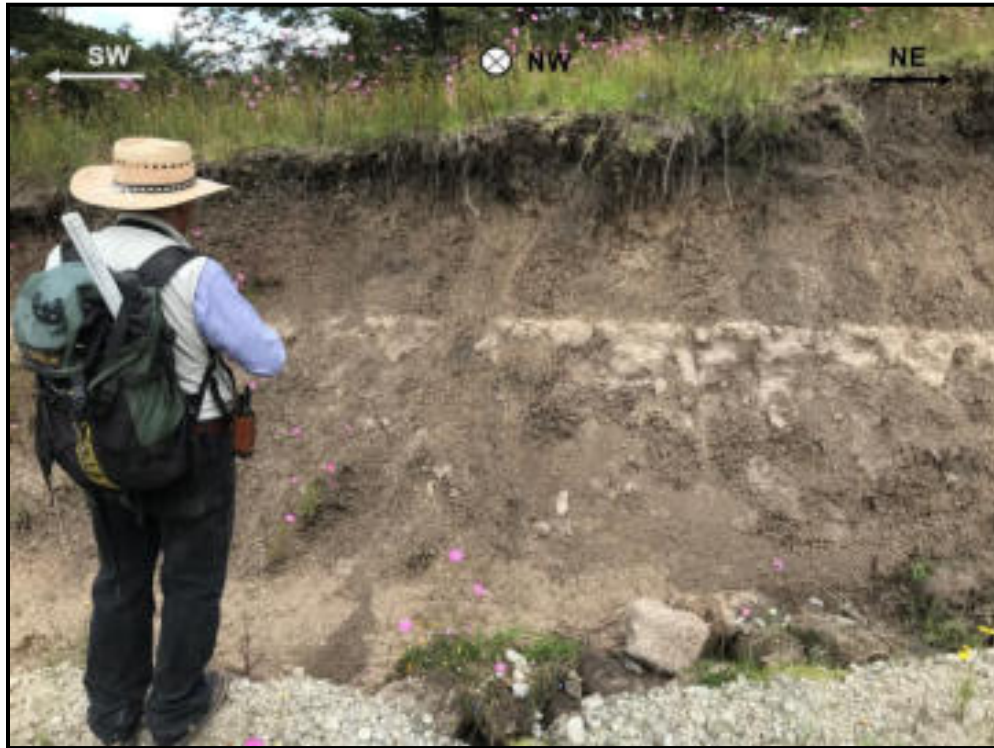
Figura 4.26 Capas de suelo y paleosuelo en la parte superior del afloramiento y a la base, cenizas volcánicas con bloques de diferentes tamaños de andesita.
