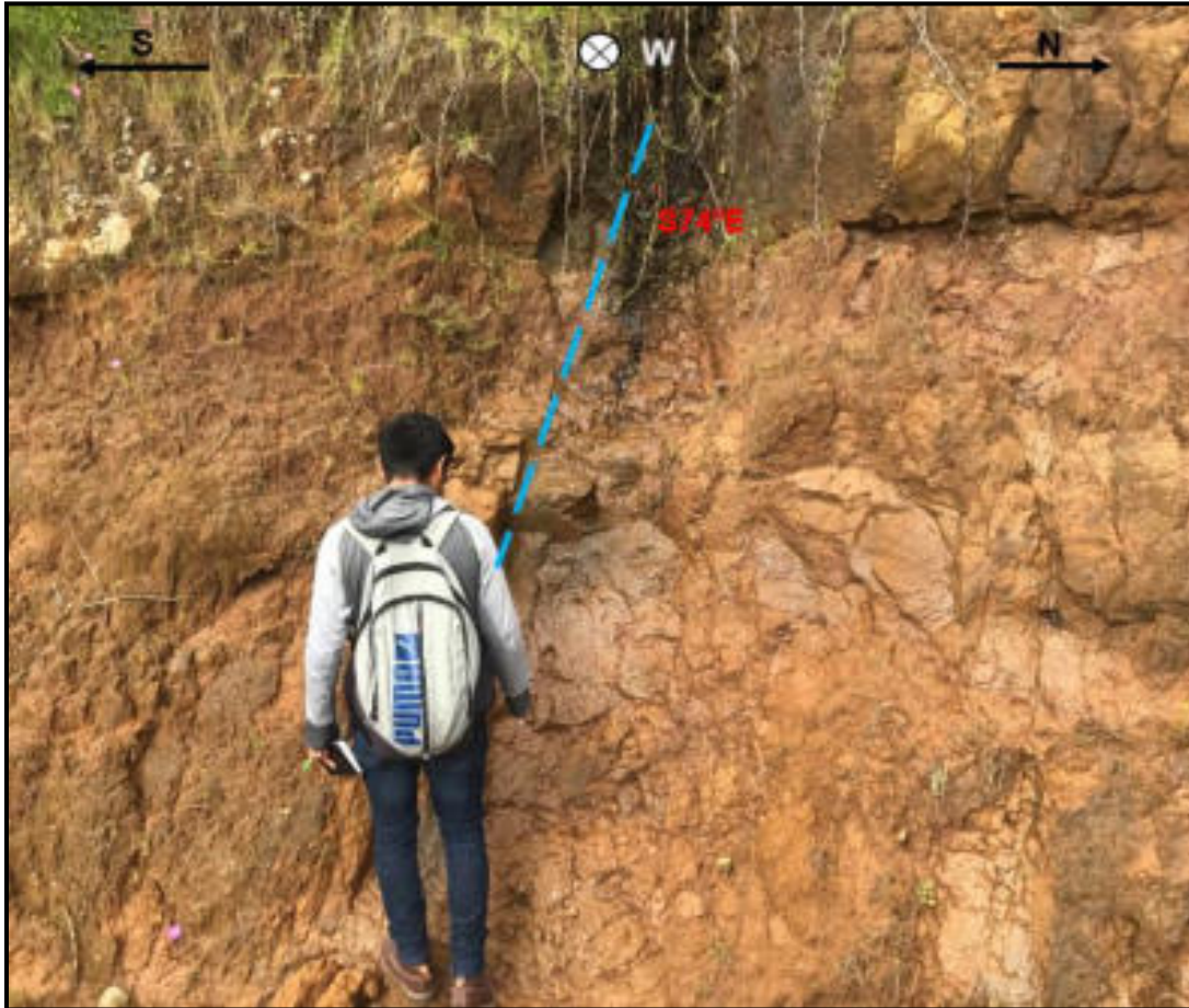
Figura 4.19 Fractura que corta cenizas volcánicas color pardo-amarillo. Las cenizas se convirtieron en arcillas color pardo, con lentes de arcilla laminada color café oscuro, con textura chiclosa, característica de arcillas expandibles.
