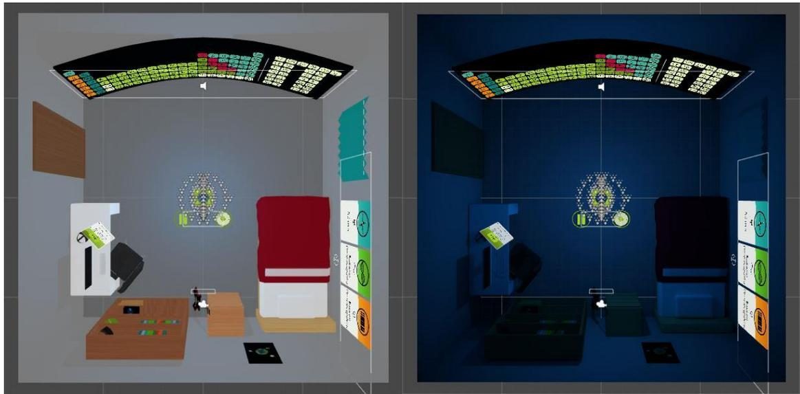
Figura 47. Antes y después de baked lighting en el nivel de VR. Fuente: Captura de pantalla de Unity.
