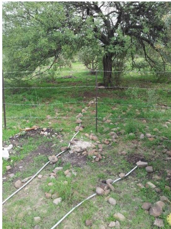
Figura 3.5 Instrumentación de tres placas para medir flujo de calor en el suelo (suelo desnudo, cubierto y semicubierto)
