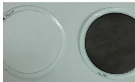
Fig. 10 **Filtro limpio y filtro con PM**
