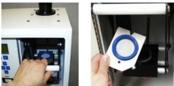
Fig. 8 **Colocación de Filtro para  $PM_{2.5}$**
