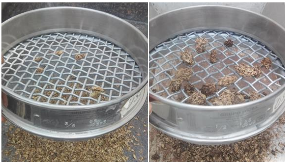
Foto 4.1 Grumos formados por las partículas de los sustratos, a la izquierda bagazo de malta y a la derecha digestato de malta
