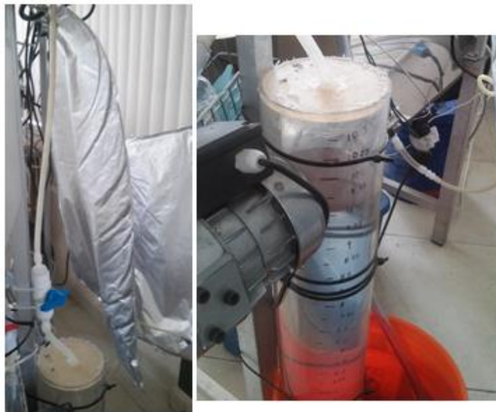
Foto 3.1 Bolsas de almacenamiento de biogás y columna de agua usada para medir la producción de biogás
