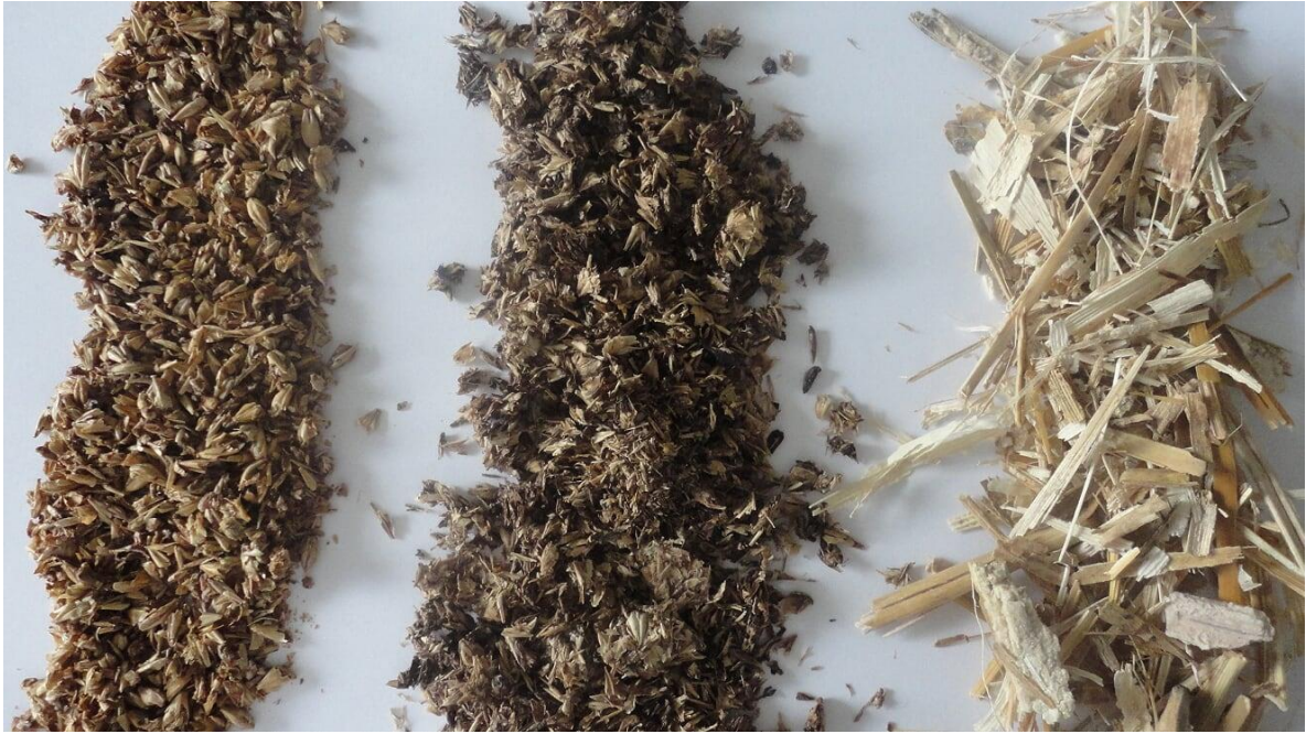
Foto 3.3 Sustratos empleados durante el método de investigación. De izquierda a derecha, bagazo de malta, digestato de malta y rastrojo de maíz
