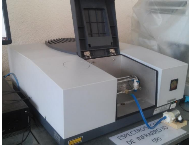
Foto 3.2 FTIR empleado para determinar la concentración de metano en el biogás
