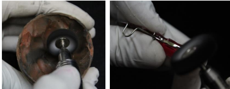
Figura 35. Proceso de pulido de las soldaduras. (Fuente propia)
