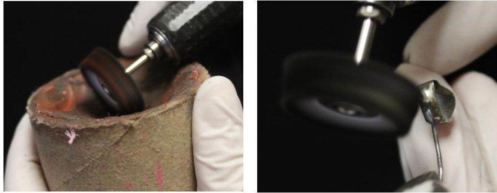
Figura 94. Pulido de las soldaduras. (Fuente propia)
