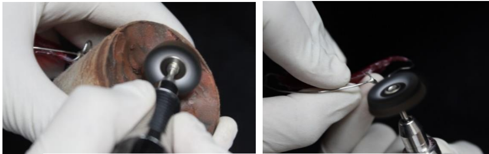
Figura 51. Pulido de las soldaduras. (Fuente propia)
