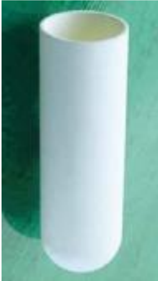
Figura 4. Cartucho de extracción. (Nuñez, 2008)
