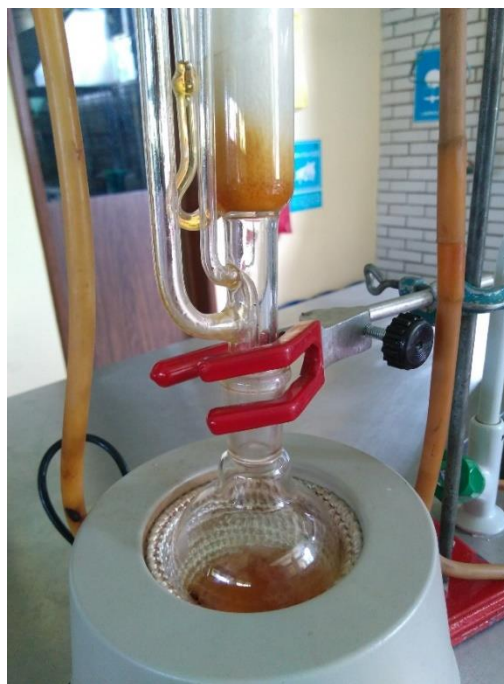
Figura 21. Coloración de solvente (EtOH/H 2 O) en último sífon.
