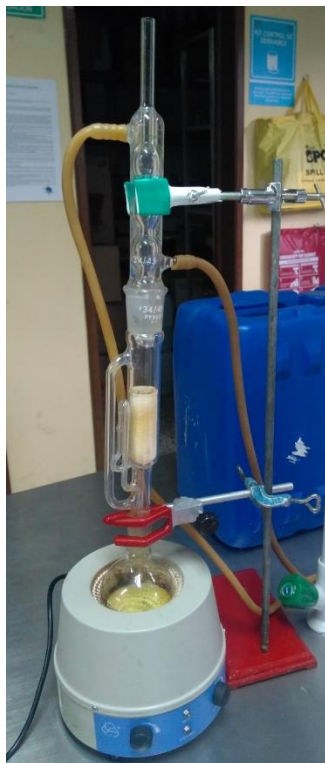
Figura 9. Equipo de extracción Soxhlet.
