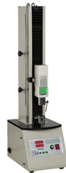
Figura 25. Sistema para calibrar la WBB con dinamómetro acoplado.
