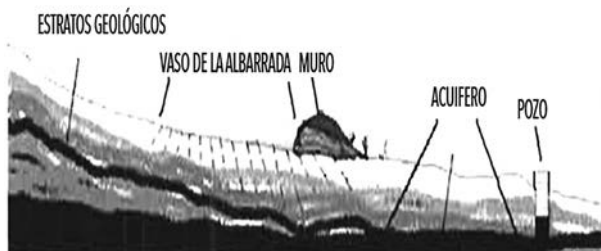
Figura 1. Mecánica de recarga de acuíferos mediante albardadas
