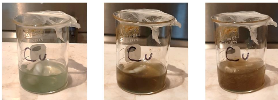
Figura 28. Solución de cloruro cuproso durante la adición de la tioacetamida.
