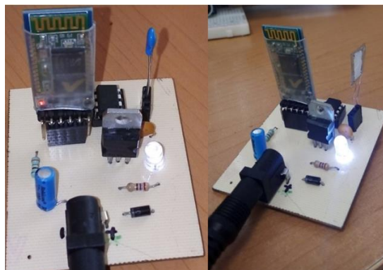
Fig. 11. Prototipo físico terminado para la adquisición de la humedad.
