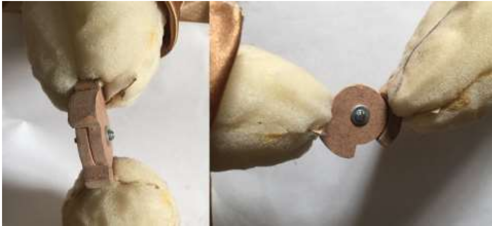
Imagen 5. Vista frontal y lateral del dispositivo articular de rodilla.
