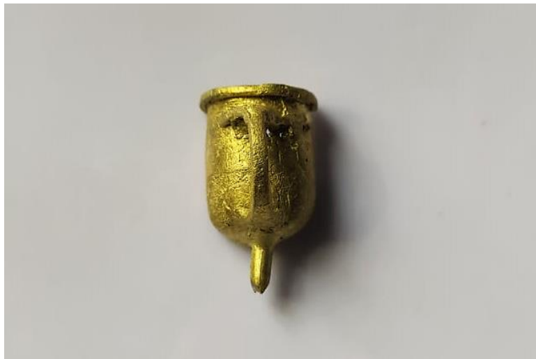
Figura 108 Máster del solitario en bruto: vista lateral Fuente: (Propia, 2020)
