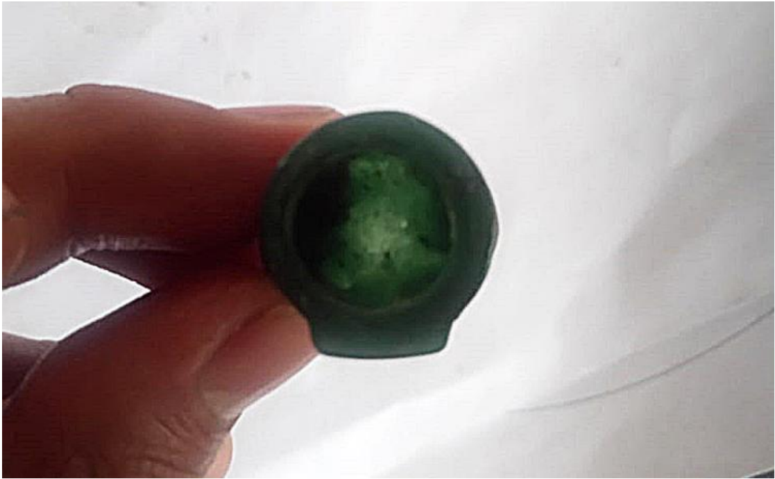
Figura 70 Modelo en cera del anillo (Vista Superior) Fuente: (Propia, 2020)
