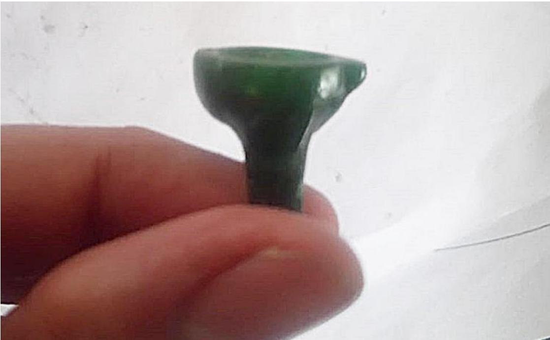
Figura 70 Modelo en cera del anillo (Vista Superior) Fuente: (Propia, 2020)
