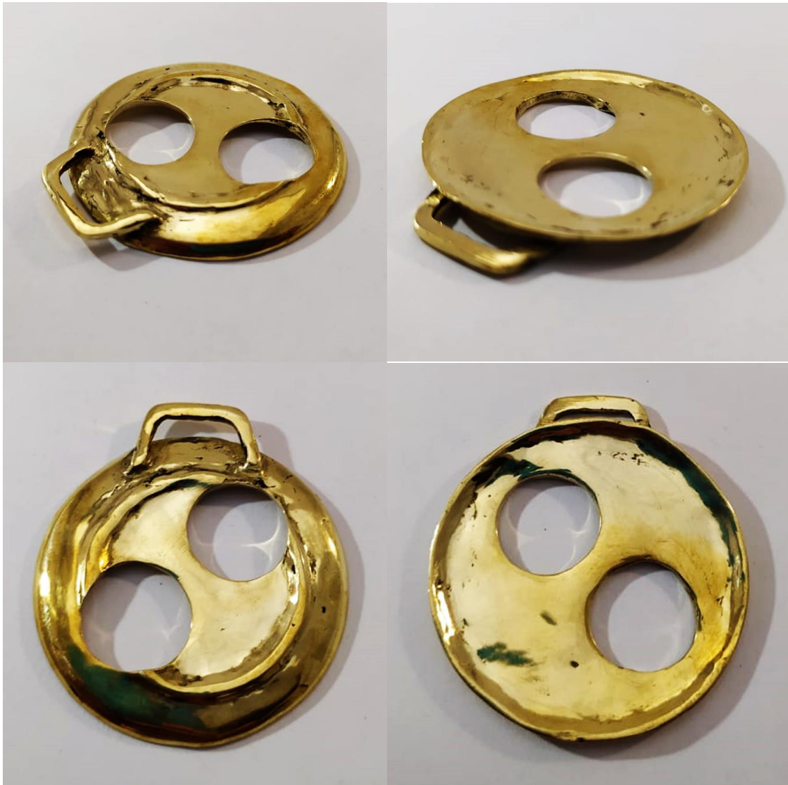
Figura 114 Master del comal lijado y pulido: vista frontal, trasera y perspectiva Fuente: (Propia, 2020)
