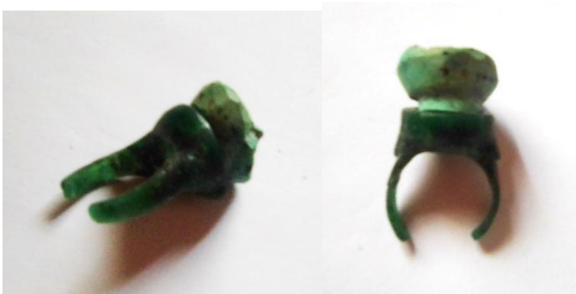
Figura 73 Modelo en cera del anillo con piedra crisocola Fuente: (Propia, 2020)
