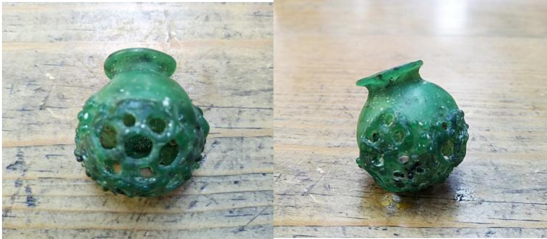
Figura 77 Modelos en cera del dije Fuente: (Propia, 2020)
