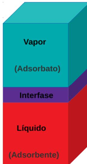
Figura 1.1: Adsorción entre las dos fases líquido-vapor.
