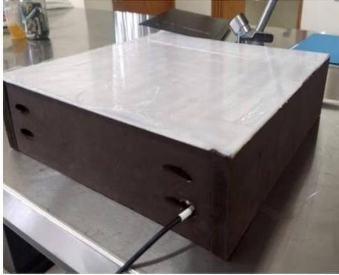
**Figura 12.** Dispositivo lumínico para determinar presencia o ausencia de fisuras en el pericarpio de granos de maíz palomero.
