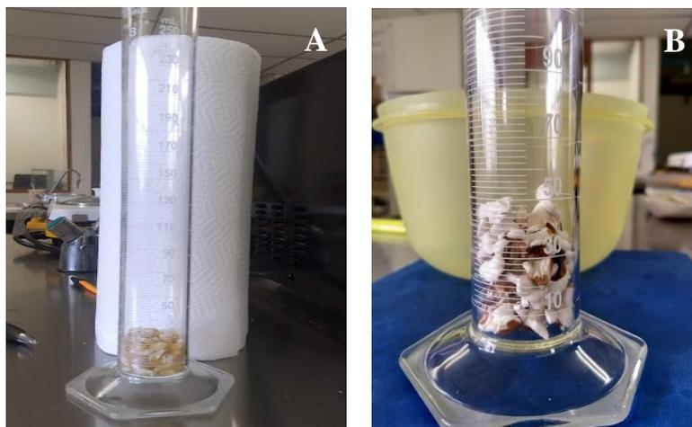
**Figura 21.** A). Determinación del volumen de granos de maíz. B). Determinación del volumen de expansión de palomitas
