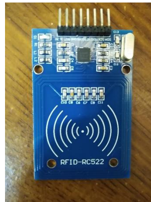
Figura 13. Lector RFID RC522 (Capturada por el autor).
