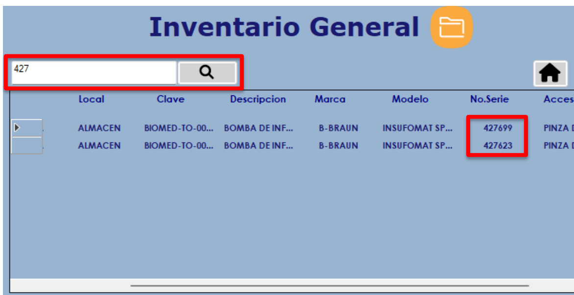
Figura 46. Búsqueda de un equipo por número de serie dentro de la ventana de Inventario General.
