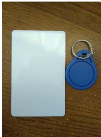
Figura 12. Etiqueta ISO 1443A en presentación de tarjeta y llavero (Capturada por el autor).
