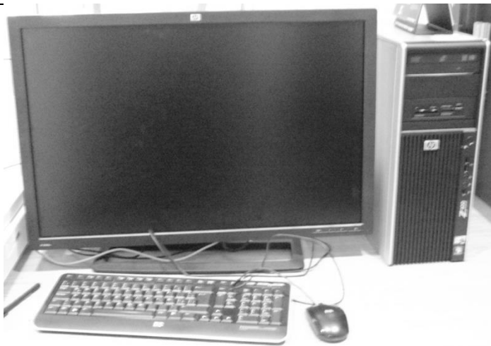
Estación de trabajo, marca hp modelo Z400, procesador Intel Xeon Dual-Core W3503 (2.40GHz), controlador ATI FirePro V3800 (512 MB), monitor: HP ZR30W S-IPS LCD entre otras características.
